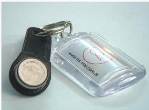
La llave I-Botton, **reconoce al conductor**, controlando tiempos de trabajo y descanso, establece velocidad máxima para el conductor en la unidad asignada y permite generar los ranquin de conducta de manejo. La misma se personaliza para cada empresa y conductor.
